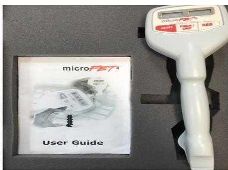
Figure 4. dynamometer
